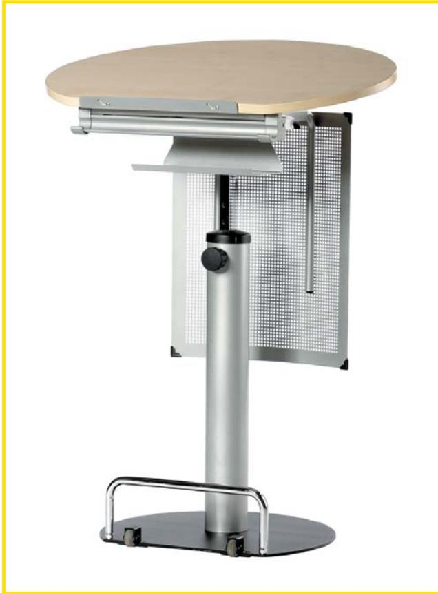
Um die Arbeit im Stehen fortzusetzen, wird das ergonomische Stehpult mittels einer Gasdruckfeder von 910 bis auf 1210 mm Arbeitshöhe eingestellt. Die Arbeitsfläche ist in der Neigung von 0° bis 15° einstellbar. Eine Ablageleiste verhindert das Herunterfallen von Arbeitsunterlagen. Mit Ablageschale 310 mm breit und 150 mm tief. Dieses Pult bietet ideale Einsatzmöglichkeiten am Arbeitsplatz, in Schulungs- und Konferenzräumen sowie in Vortragssälen.
